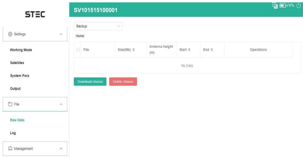
Poin yang dikumpulkan dalam SurPad4.x akan dicadangkan dalam penyimpanan receiver secara otomatis untuk menghindari kehilangan data. Dapat mengembalikan data ke perangkat lunak SurPad.
